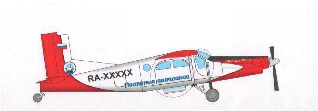
Рис.29 Схема размещения дверей воздушного судна PC-6/B2-H4
