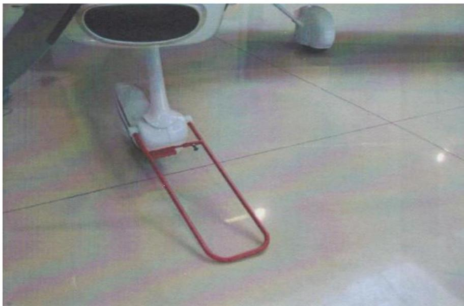
Рис. 90 Буксировка самолета DA-40NG
